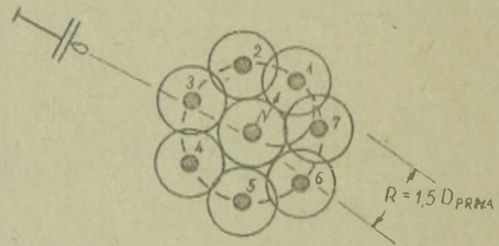
Rys.19. Stawianie pław radiohydroakustycznych w kształcie okręgu
