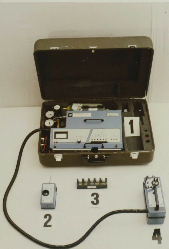
Zdj. 20 - "EXPLOTEST-100" - - elektroniczny analizator oparów materiałów wybu- chowych:
