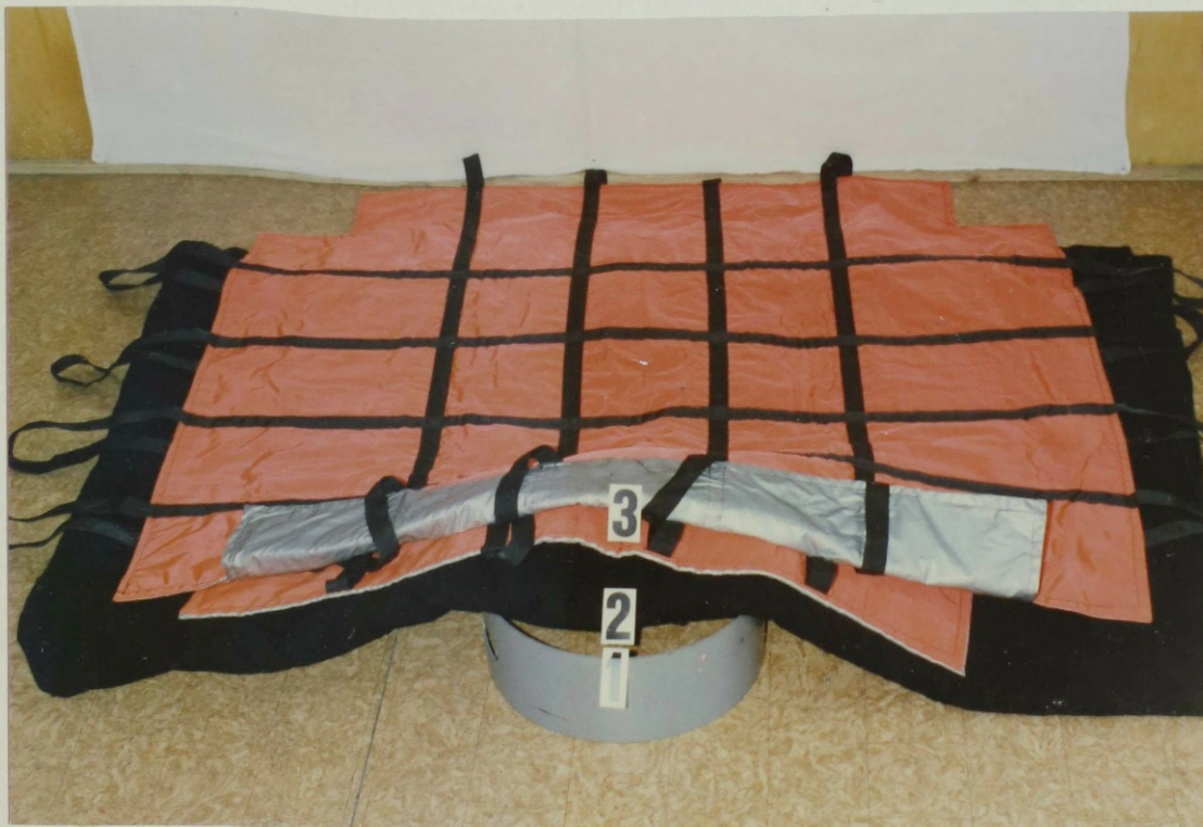
Zdj. 22 - Koc antywybuchowy: 1 - pierścień dystansowy 2 - warstwa spodnia 3 - wierzchnia warstwa kevlarowa
