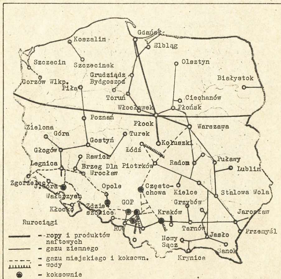
Rys.13. Sieć rurociągów /wg T.Lijewskiego/.
