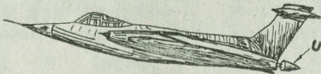
Rys. 18. Urządzenie "U" ekranujące promieniowanie na podczerwień zastosowane na samolocie "Buccaneer-2".
