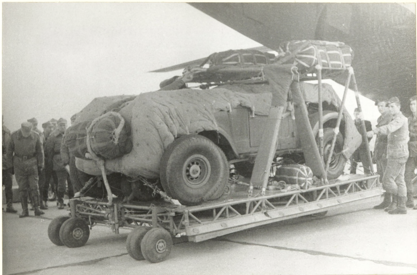
10 PLATFORMA P-127 PRZYGOTOWANA DO ZRZUTU PRZED ZAŁADOWANIEM DO SAMOLOTU
