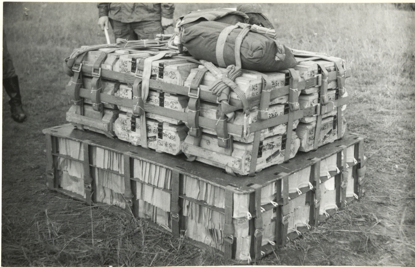
14 PLATFORMA PGS-500 ZAŁADOWANA AMUNICJĄ I PRZYGOTOWANA DO ZRZUTU
