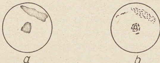
Rys. 8. Oddziaływanie zakłóceń biernych na stacje radiolokacyjne o różnej rozróżnialności
