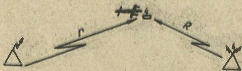
Rys.5. Zakłócanie radiowego odbiornika rozmieszczonego na samolocie.
