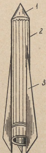
Rys.2 Rakiet Siemianowicza 1-kotpak; 2-korpus; 3-brzechwy
