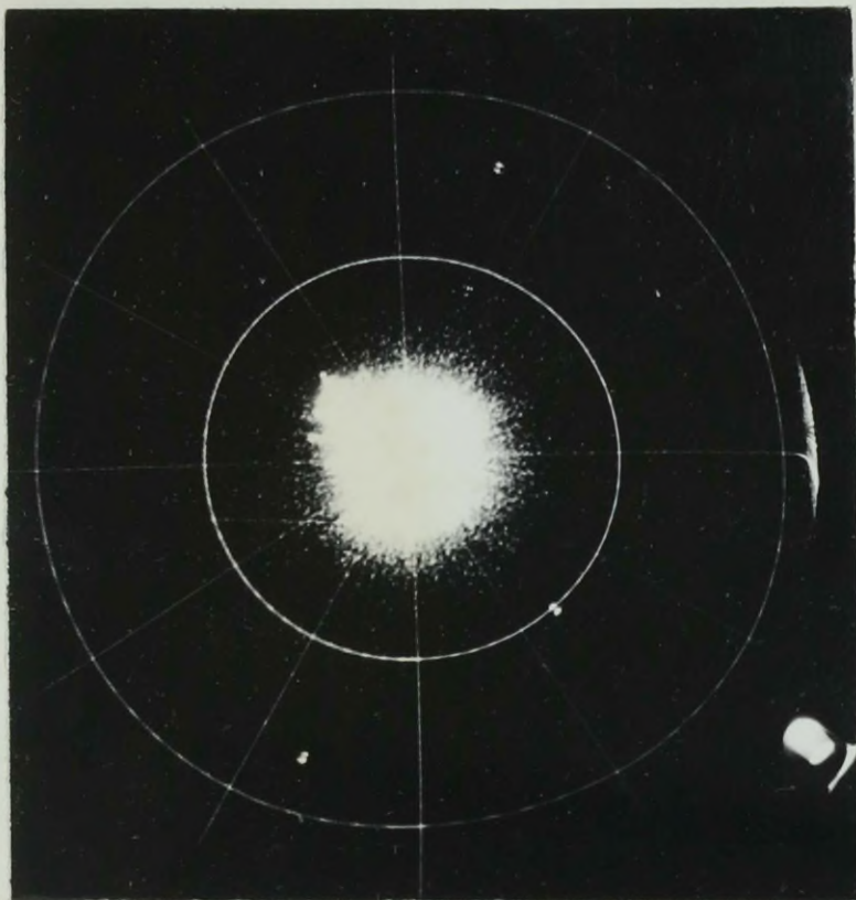
Zdjęcie 42. Zakłócenia wzajemne na wskaźniku P; RLS JAWOR-M; RLS zakłócająca - SSWN; odległość wzajemna - 500 m.
