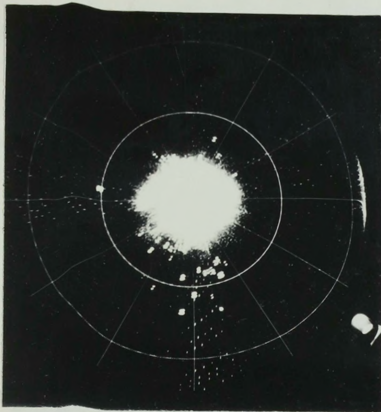
Zdjęcie 27. Zakłócenia wzajemne na wskaźniku P, RLS JAWOR-M; RLS zakłócająca JAWOR M; odległość wzajemna 15000 m; kąt zorientowania anteny RLS zakłócającej 0^{\circ} , zakłócanej 0-360^{\circ} .
