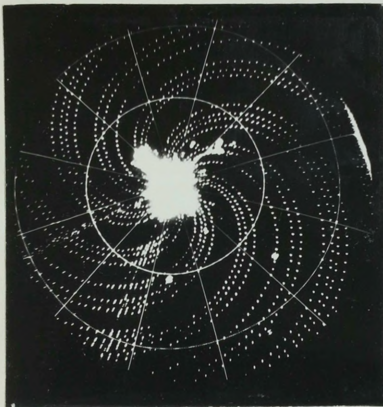
Zdjęcie 21. Zakłócenia wzajemne na wskaźniku P-RLS JAWOR-M; RLS zakłócająca JAWOR-M; odległość wzajemna 8000 m; kąt zorientowania anteny RLS zakłócającej 0^{\circ} , zakłócaanej 0-360^{\circ} .
