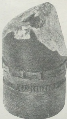
Rys. 68. Pocisk przeciwpancerny działka 37 mm, który przebił pancierz na czołgu Renault grubości 16 mm z odległości 400 m; pocisk pękł.
