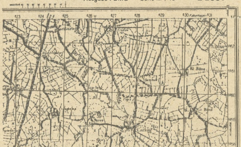
Rys. 1 Fragment mapy NRF na skali 1:50 000 z oznaczeniem serii, z lewej strony ramki podziałka w tysięcznych dla określenia kierunku północy magnetyznej z prawej strony - nomenklatura mapy.
