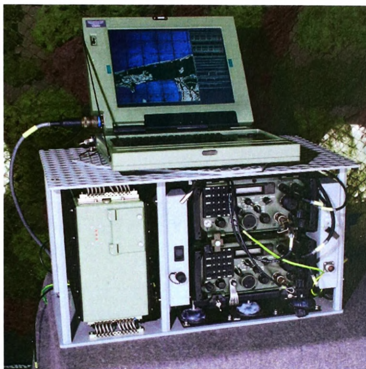
Foto. 3. Terminal REGA-2 dla zestawów przeciwlotniczych: S.A.-6 (KUB) i S.A.-8. (OSA)
