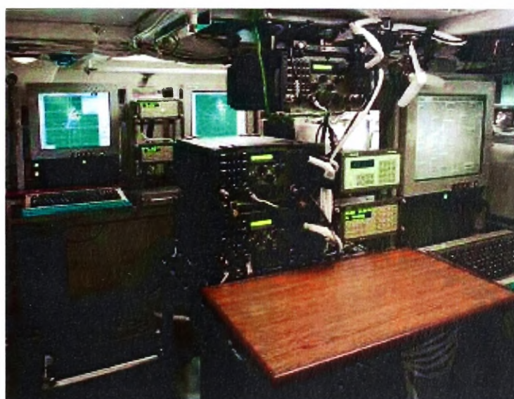
Foto. 1. Widok wnętrza kabiny ZWD Łowcza- 3R z trzema zautomatyzowanymi stanowiskami pracy
