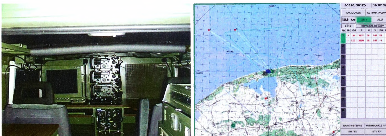
Foto. 2. Główny ekran pracy bojowej w wozie dowodzenia REGA-1
