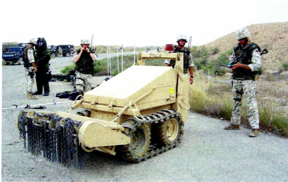
Rys. 3.12. Trał „Mini Flail” wykorzystywany przez polskie pododdziały w Afganistanie w ramach wsparcia sprzętem przez pododdziały Stanów Zjednoczonych.
