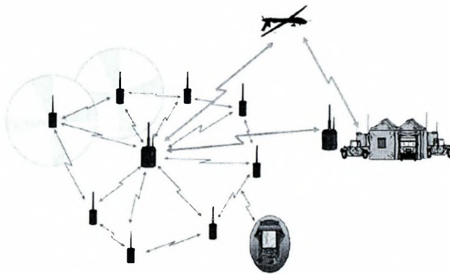
Rys. 3.3. Struktura nienadzorowanej bezprzewodowej sieci teleinformatycznej sensorów (przykład)
