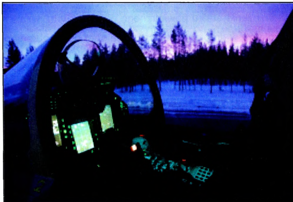
Rys. 33. Wskaźniki parametrów lotu i sytuacji taktycznej HUD i HDD samolotu wielozadaniowego Eurofighter Typhoon
