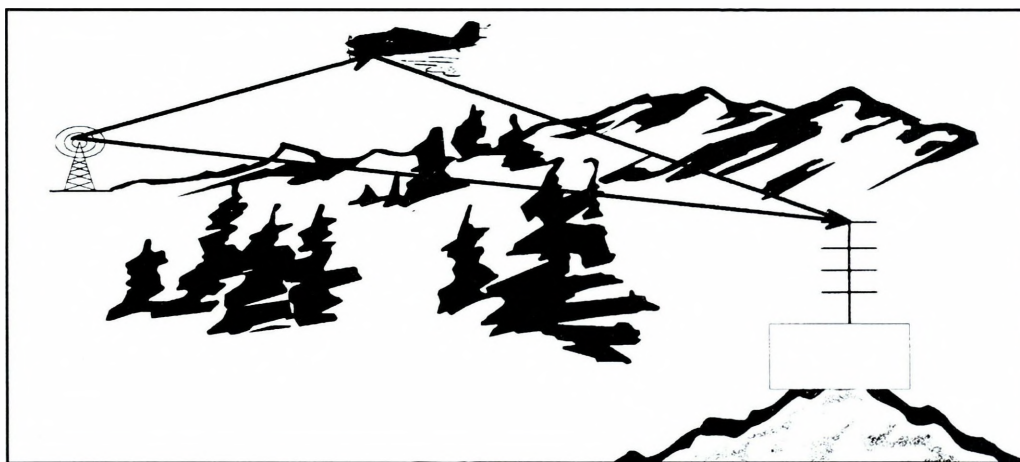
Rys. 8. Pasywny system bistatyczny
