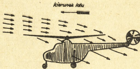
Rys.7 Skośny opływ wirnika śmigłowca
