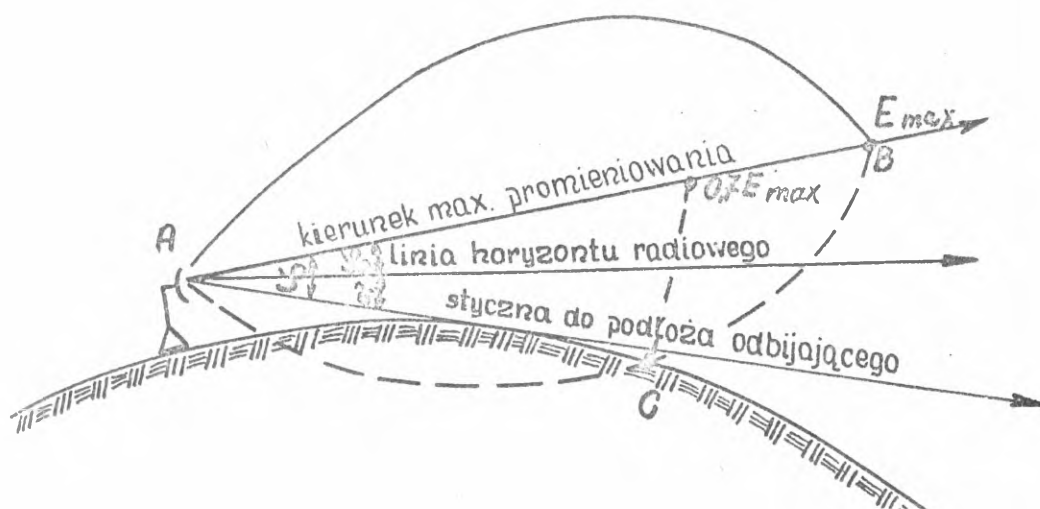
Rys. 65. Normowana kierunkowa charakterystyka promieniowania anteny RLS.
