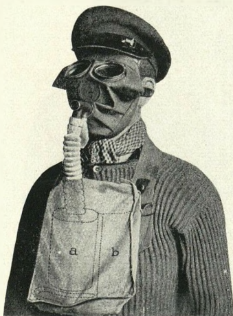
Abb. 17. Englischer Box- Respirator mit Gesichtsmaske 1917. Bereitschaftstasche mit Atmungs- patrone, hochgeknüpft. a = Absorptionspatrone; b = Taschenteil zum Einlagern von Maske und Atmungsschlauch.
