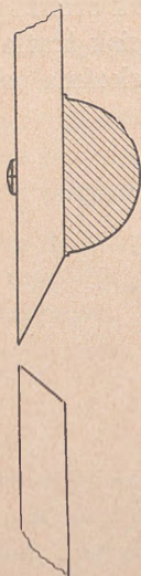
Ryc. 56. Szczelina obserwacyjna wycięta w pancerzu jest wąska ze strony zewnętrznej, rozszerza się od wewnątrz (aby powiększyć kąt widzenia), część zakreskowana — poduszka, o którą się opiera czoło obserwatora, chroniącego w ten sposób twarz od uderzeń o pancerz.
