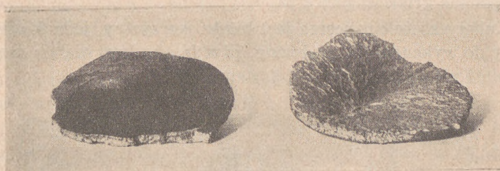
Ryc. 16. Tzw. „korki”, tj. wyłamania w zbyt twardym pancerzu pod wpływem uderzenia pocisku.
