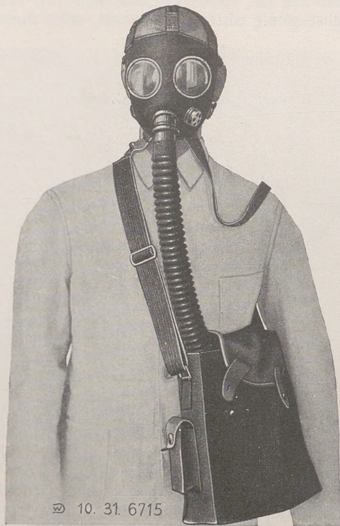
Abb. 21. Filtergeräte. Zweiweg-Atemmaske mit Ausatemventil und Filterbüchse (Schwebstofffilter), die in einer Tragtasche untergebracht ist. Die Filterbüchse ist durch einen Zwischenschlauch mit der Maske verbunden. (Drägerwerk, Lübeck)
