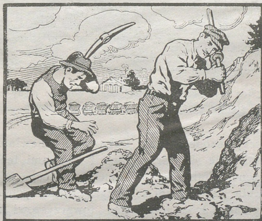
Rys. 119. Oto skutki źle osadzonego narzędzia.
