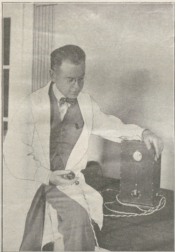
Rys. 54. Asystent pracowni, p. Macewicz z przyrządem własnego pomysłu do pomiarów reakcji wzrokowej, słuchowej i dotykowej.
