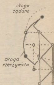
Rys. 61. Nieprawidłowa konstrukcja muszki wiatrowej o regulowanym ramieniu.
