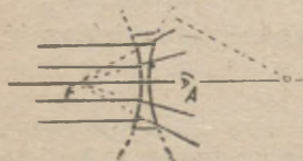
Rys. 99. Bieg promieni w soczewce rozpraszającej.
