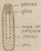
Rys. 207. Pocisk zapalający uderzeniowy.
