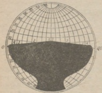
Rys. 194. Martwe pole ostrzału w przedniej półkuli (w rzucie kulistym).
