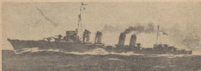
Francuski leader „Bison“ budowy 1927 r. wyporność 2800 ton, szybkość 37 węzłów, (na próbach 41,2 węzła), uzbrojenie: 5-138 m/m, 4-37 m/m plł, 6 wyrzutni torpedowych
