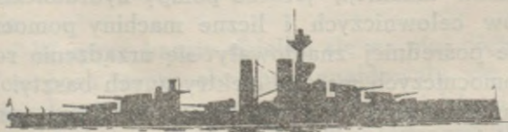
Pancernik brytyjski King George . Wyporność 23000 tonn. Szybkość: 21 węzłów. Uzbrojenie: 10 dział 343 mm. Salwa jednej burty — 6350 kg.
