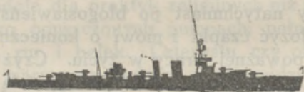
Lekki krążownik brytyjski Cardiff , 4200 tonn, szybkość 29 węzłów.
