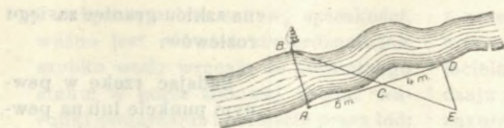
Rys. 50. Mierzenie szerokości rzeki. (1)
