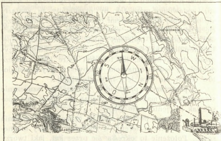
Rys. 41. Oznaczenie położenia pewnego punktu w terenie i na mapie przy pomocy kąta kierunkowego.
