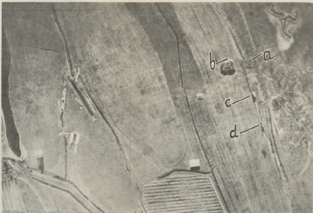
RYS. 144. Zdjęcie lotnicze z wysokości 300 m odcinka urządzeń fortyfikacyjnych ze stanowiskiem dla dział. a) działo okopane, dobrze zamaskowane (jak rys. 143), b) działo nieokopane, c) wóz pontonowy, zamaskowany, d) wóz pontonowy niezamaskowany.
