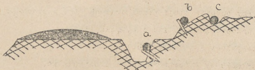
Rys.53. Umieszczanie kabla wzdłuż drogi.
