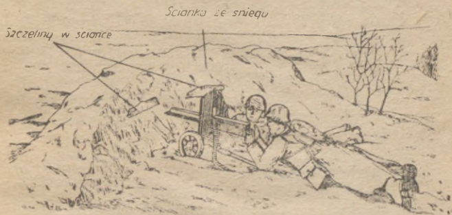
Rys. 8. Maskowanie karabina maszynowego ścianką ze śniegu. Czas budowy: dwóch strzelców, 15 minut
