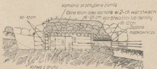
Krys. 103. Lekki schron dla ckm w górach, przystosowany do strzelania z pozycji leżącej
