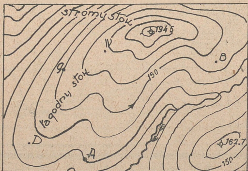
Rys. 32. Określenie wysokości punktów wg mapy.
