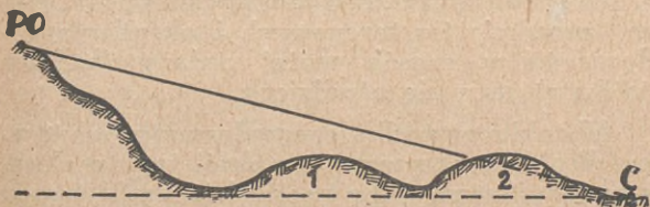
Rys. 34. Zależność widoczności od wzajemnego położenia punktu obserwacji i przeszkody.
