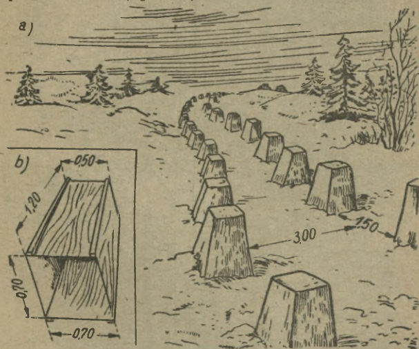
Rys. 75. Budowa pozornych palisad ze śniegu imitujących betonowe: a — ogólny widok gotowej palisady; b — forma do ubijania śniegu
