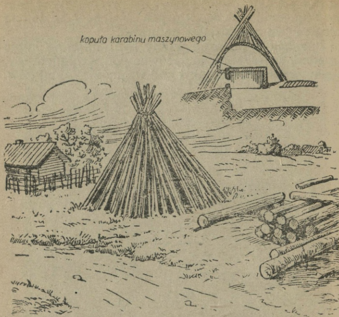
Rys. 84. Maskowanie kopuły żelazo-betonowej za pomocą żerdzi
