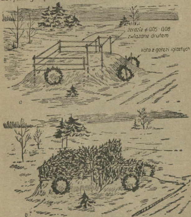
Rys. 66. Pozorny samochód ze śniegu, żerdzi i gałęzi iglastych: a — budowa szkieletu z żerdzi; b — widok ogólny; czas budowy — 5 rob. godz.
