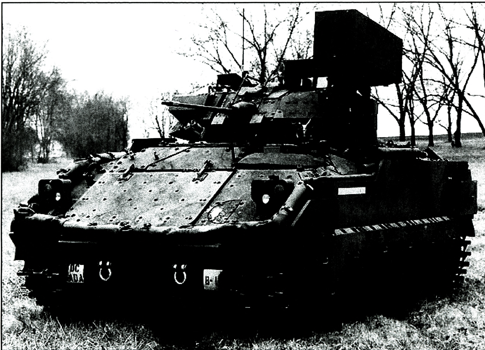
Rys. 76 Przeciwlotniczy samobieżny zestaw rakietowy BSF-E / Bradley Stinger Vehicle - Enhanced /
