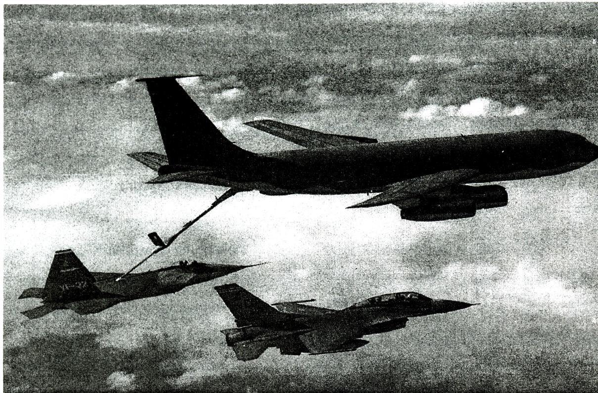
Rys. 1. Samolot KC-135 z systemem tankowania „Flying Boom System”
