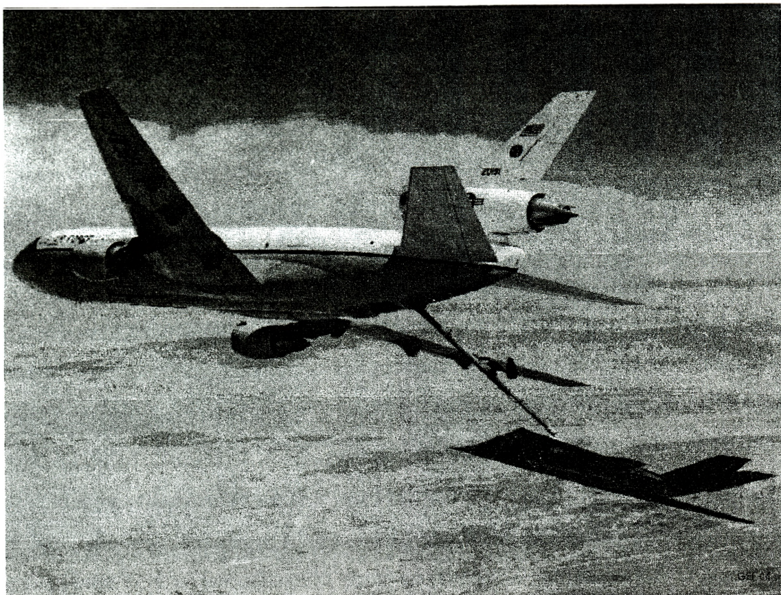
Rys. 3. Samolot KC-10 z systemem tankowania „Flying Boom System”
