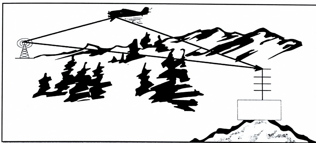
Rys. 1.12. Pasywny system bistatyczny
