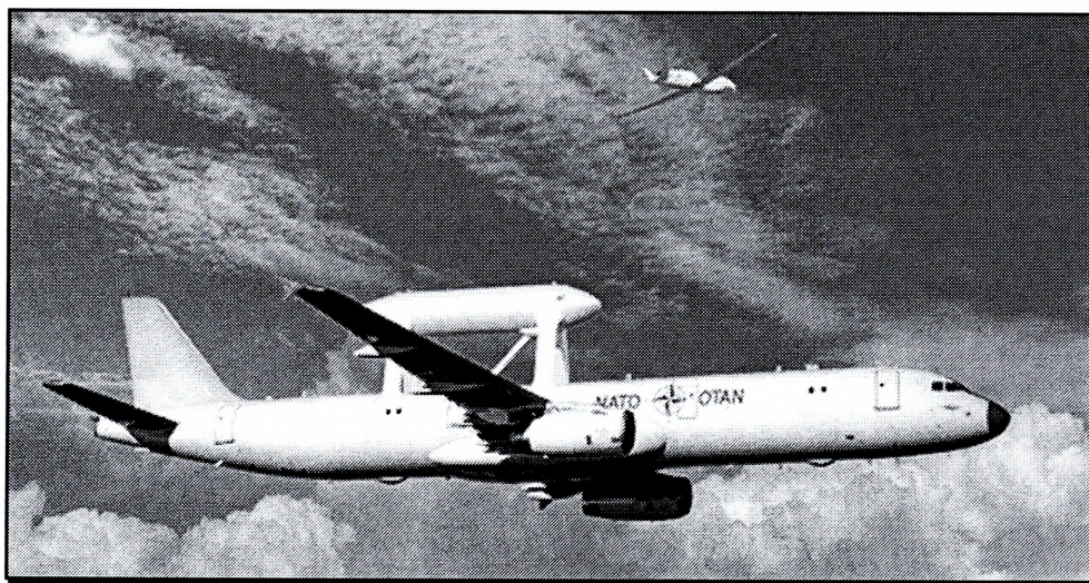
Rys. 2.7. Antena nowego systemu radarowego na samolocie Airbus A321 umieszczona na specjalnej konstrukcji nad tylną częścią kadłuba
